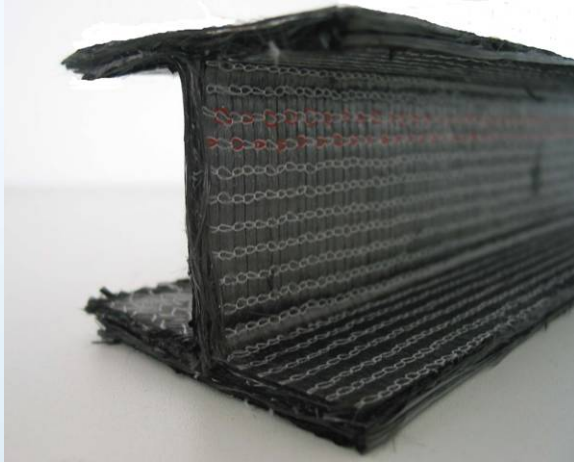
Preform eines Stringerprofils hergestellt mit STX-Gelege mit Pulverbinder
